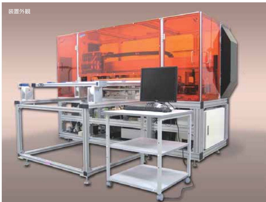
装置正面：搬送部イメージ ソリ防止の為に治具がついています。
