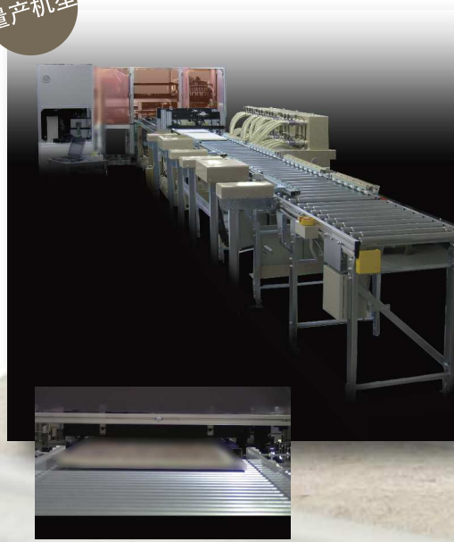
传送带输送过来的基材推至一端
